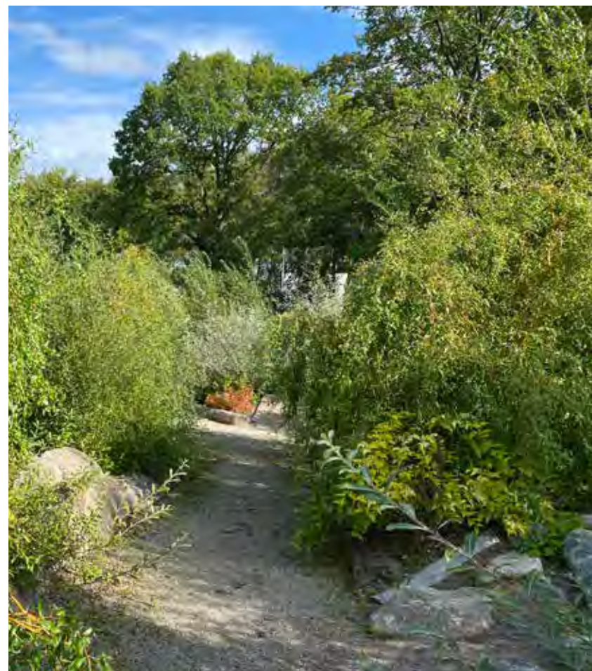
Kullar av återbrukade schaktmassor täckta av ca 10 cm natursand bildar växtbädd för salixbuskar i Hjälmaviksparken.
